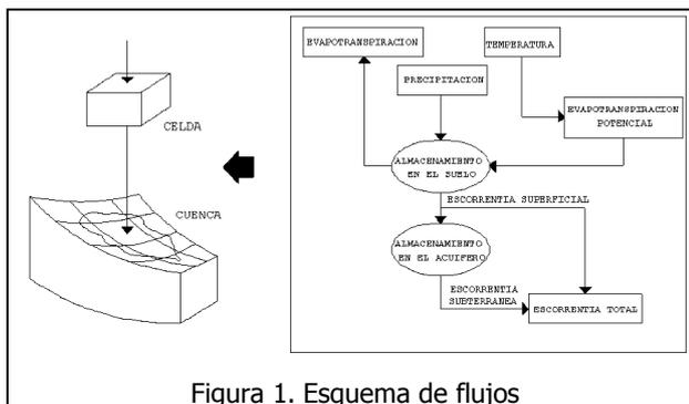
Figura 1. Esquema de flujos
