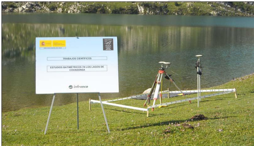
Estación base, GPS cinemático referenciándose y GPS tomando posición real de la estación base.
