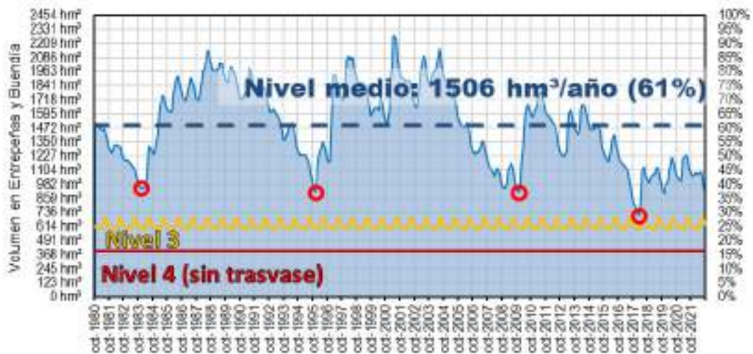
Figura 11. Evolución de niveles en Entrepeñas y Buendía en el escenario nº 7. Los círculos rojos marcan los mínimos tras un periodo seco
